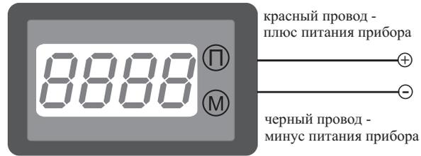
Рис. 1. Подключение прибора.
