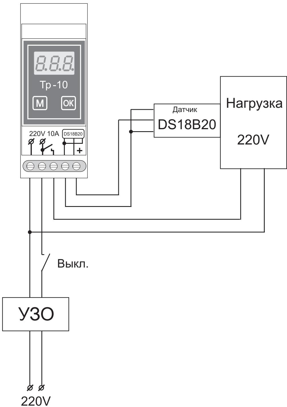
Рис.1 Вариант монтажа системы.
